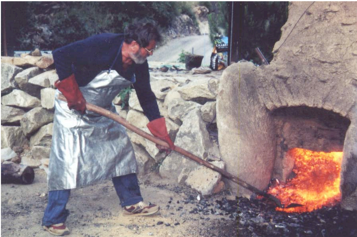
Fig.-56.-Reconstrucción de un horno siderúrgico romano, plataforma experimental de Lastours (final del proceso de reducción de hierro, junio de 2000).
