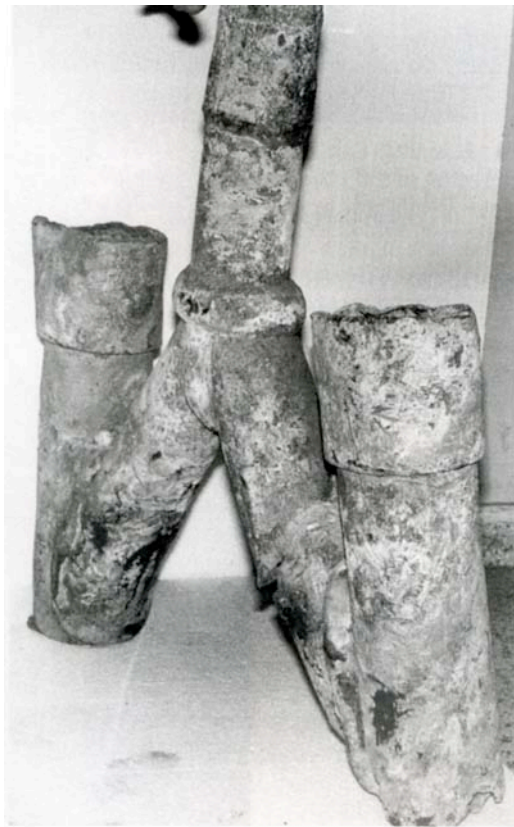
Fig.-14.-Bomba de Ctesibio, construida con plomo, Corta Emilia, Sierra de Cartagena.
